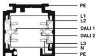
Les 3 phases et les bornes DALI sont indépendantes et isolées les unes par rapport aux autres. Il est ainsi possible d'adresser les luminaires et de les contrôler en DALI (1-10V sur demande) tout en conservant les 3 phases sur le même rail. Les bornes prévues pour le signal de control peuvent être utilisées pour un éclairage de secours si ces dernières ne sont pas utilisées pour le contrôle des luminaires.
