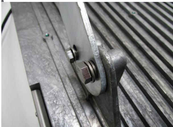
Beide Querstreben mit Sechskantschrauben, Unterlegscheiben und Nord-Lock-Scheiben wie dargestellt an der Leuchte mit Maulschlüssel 17 mm und 19 mm befestigen.
