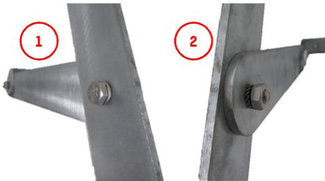
Querstreben im gewünschten Winkel mit Maulschlüssel 17 mm (17 Nm) fixieren. Dabei erst die Schraube anziehen (1) und anschließend mit der Mutter sichern (2).
