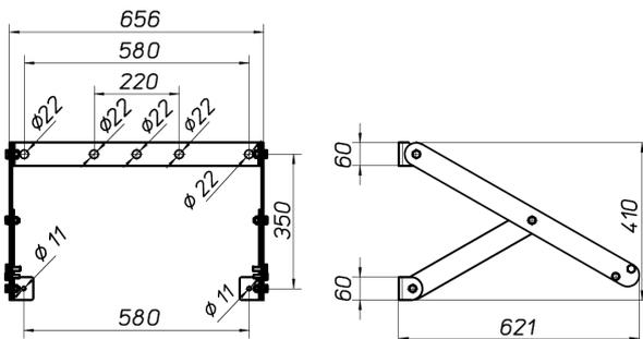
Alle Schrauben mit Maulschlüssel 17 mm und 19 mm fest anziehen (jeweils 17 Nm).
