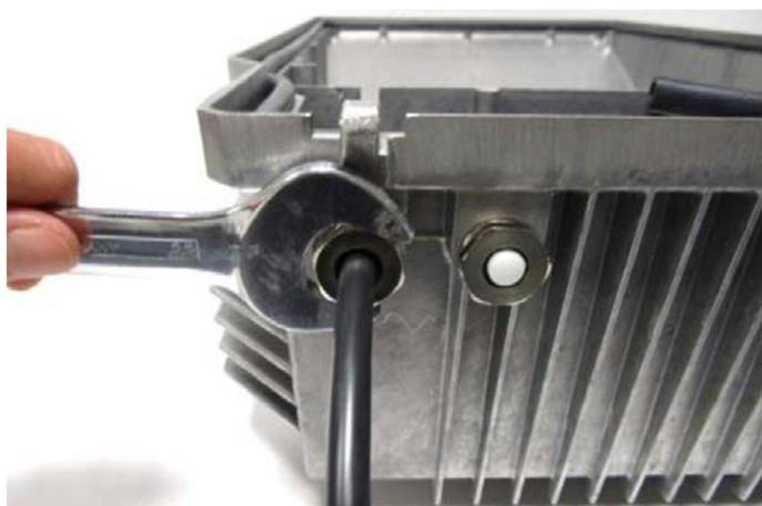
Une fois le raccordement effectué, fixer le presse-étoupe avec une clé de 22mm en assurant un couple de serrage de 8 Nm
