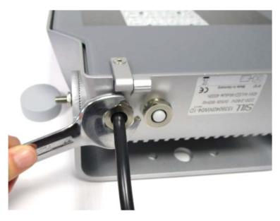
Une fois le raccordement effectué, fixer le presseétoupe avec une clé de 22mm en assurant un couple de serrage de 8 Nm
